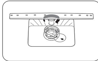
3. Grotere etensresten kunnen worden verwijderd door het filter onder stromend water af te spoelen. Gebruik een zachte borstel voor een grondigere reiniging.
