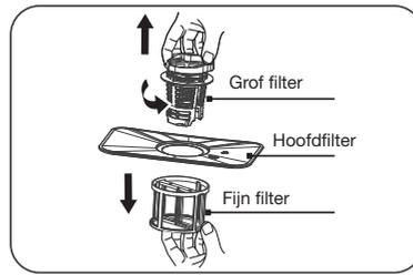
1. Pak het grove filter beet en draai het linksom om het te ontgrendelen. Til het filter omhoog uit de vaatwasser.
