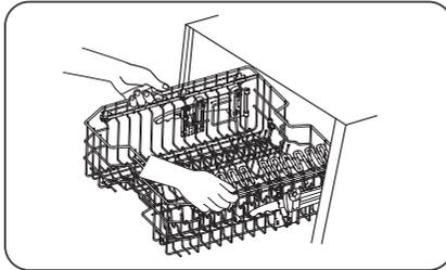
2. Om de korf lager te zetten, tilt u beide hendels omhoog om de korf los te maken en laat u de korf in de onderste stand zakken.
