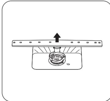
3. Was de sproeiarmen met zeep en warm water en gebruik een zachte borstel om de mondstukken te reinigen. Plaats de sproeiarmen terug nadat u deze grondig hebt afgespoeld.
