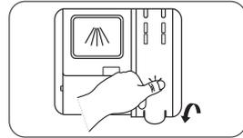
1. Ouvrez le bouchon du réservoir.
