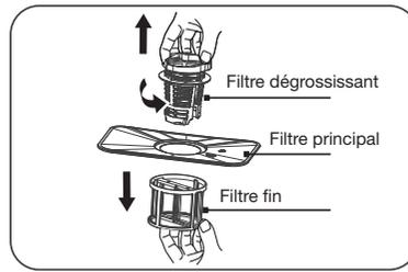
1. Tenez le filtre dégrossissant et faites-le tourner dans le sens antihoraire pour déverrouiller le filtre. Soulevez le filtre et sortez-le du lave-vaisselle.
